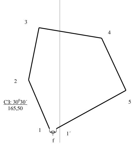
Абсолютная невязка f = 1...1' =\_\_\_\_\_ м. Относительная невязка m = f : P (периметр участка) =\_\_\_\_\_
